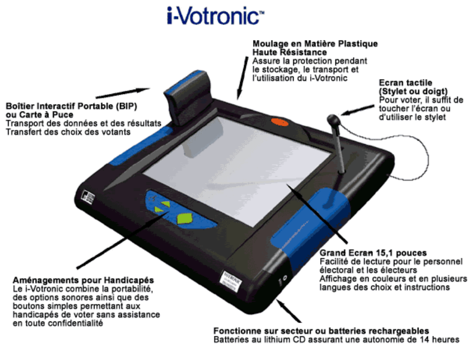
Figure 4. Exemple de terminal de vote électronique, type i-Votronic™ développé par la société Diebold Elections System, avec options sonores et boutons simples permettant aux handicapés de voter sans assistance en toute confidentialité.
