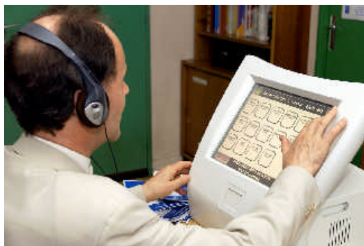
Figure 1. Terminal de vote à écran tactile et assistance sonore destiné aux handicapés, utilisé pendant l'expérimentation de vote électronique du projet européen E-POLL à Vandoeuvre-les-Nancy, France, en juin 2002.
