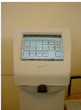
Figure 2. Terminal de vote à écran tactile développé pour le projet européen de vote électronique E-POLL.
